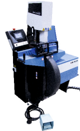
CM 91 Hortum Soyma Makinası 4"e kadar R1-R2-4SH-R13 hortumları keser. Duman atıcı + Hortum kesme tablası + Ayak pedalı + Savaş özelliği vardır.
